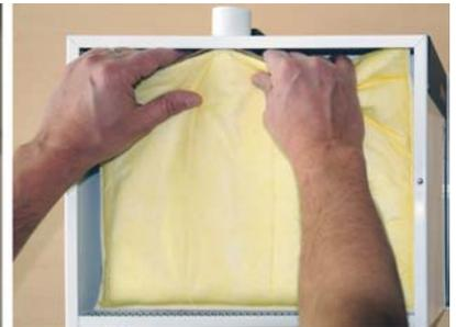
3. Ziehen Sie den Filterbeutel vom Stutzen ab und stecken einen neuen Filterbeutel auf.
