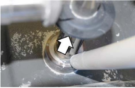
5. Es wird empfohlen, so viel Staub wie möglich von der Werkstückachse abzusaugen. Entfernen Sie unbedingt auch den Staub an der Unterseite der Prallscheibe der Blockachse (siehe Pfeil).
